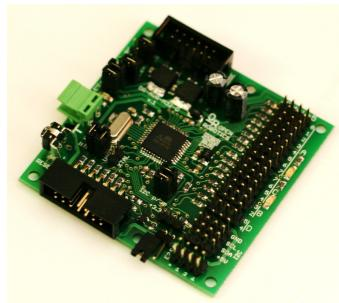
Контроллер общего назначения OR-AVR-M32-D предназначен для управления устройствами (сервоприводами, ИК-дальномерами, контактными бамперами и т.д.) мобильного робота колёсного или гусеничного типа на коллекторных двигателях, может выступать как в качестве головного, так и в качестве вспомогательного контроллера.
