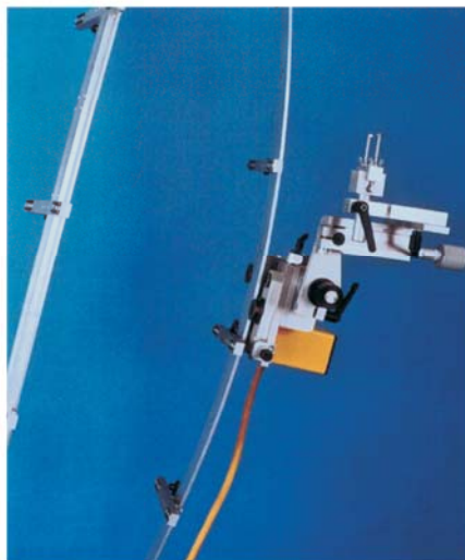
При помощи жесткой планки, закрепляемой на гибком направляющем рельсе, направляющий рельс становится жестким.
