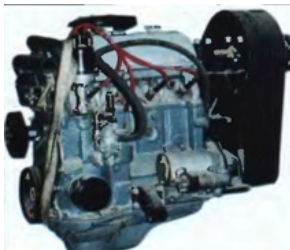
Адаптированный мотор от автомобиля «Жигули» (ВАЗ 3-й модели) к авиаварианту с воздушным винтом.
