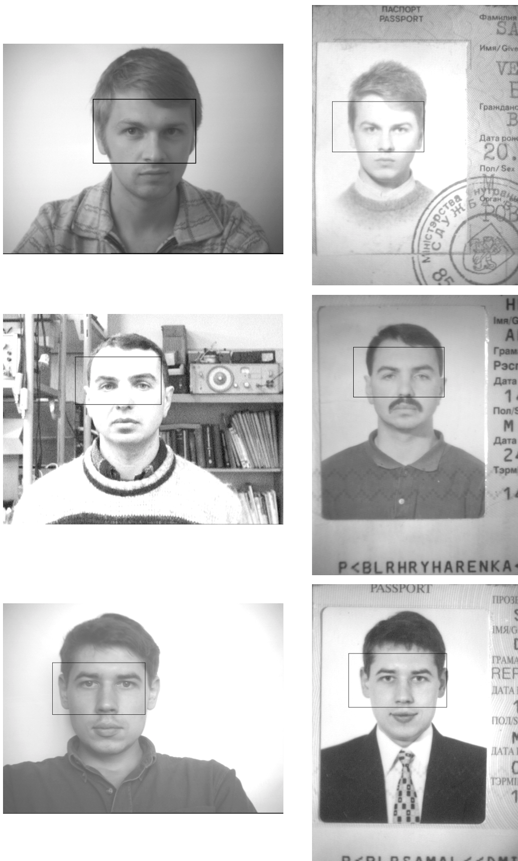
Рис. 2.4. Пример результатов работы алгоритма поиска области лица на фотопортретах: на паспортных и на поступающих с видеокамеры изображениях
