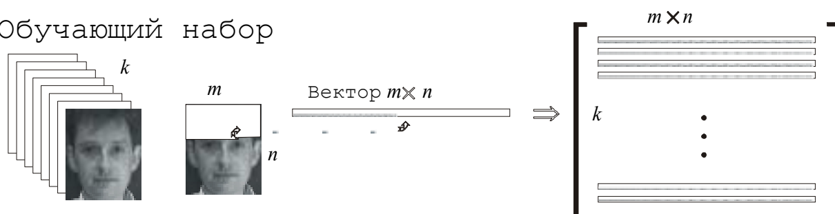
Рис. 1.6. Формирование k векторов для последующего определения главных компонент обучающего набора
