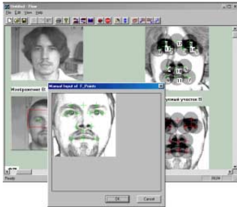
Рис.4.4. Пример результата работы блока ручной коррекции координат антропометрических точек лица. На рисунке показано основное и вспомогательные окна программы
